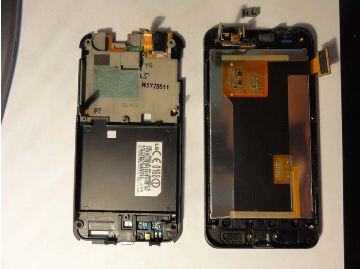
10. Das Display vom Glas trennen: Vorsichtig mit einem Schlitz Schraubenzieher abhebeln (ist LEICHT angeklebt)
