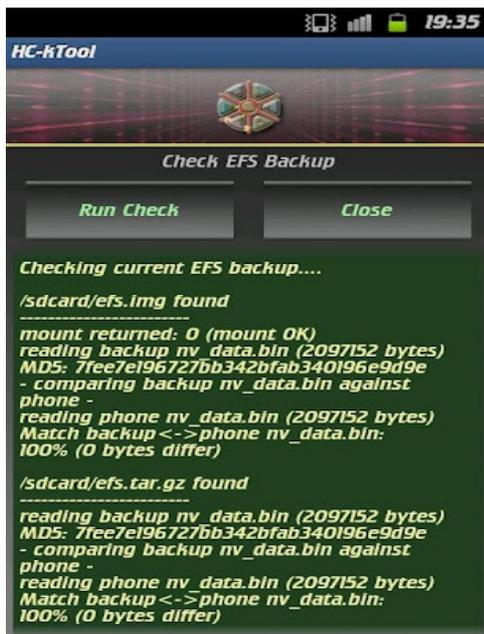
**Die Prüfung ist abgeschlossen und es sollten keine Fehlermeldungen und Abweichungen gemeldet werden (Backup found/0 bytes differ)**
