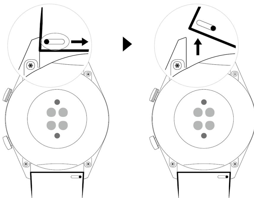
Führen Sie zum Entfernen eines Metallarmbands die in der nachfolgenden Abbildung dargestellten Schritte aus. Führen Sie die Schritte in umgekehrter Reihenfolge aus, um ein neues Armband anzubringen.
