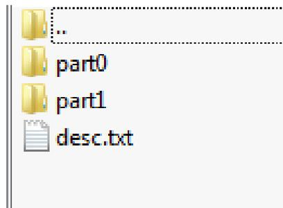
part0, part1 ist die Reihenfolge, wie die Animation abgespielt wird, diese wird durch desc.txt festgelegt.
